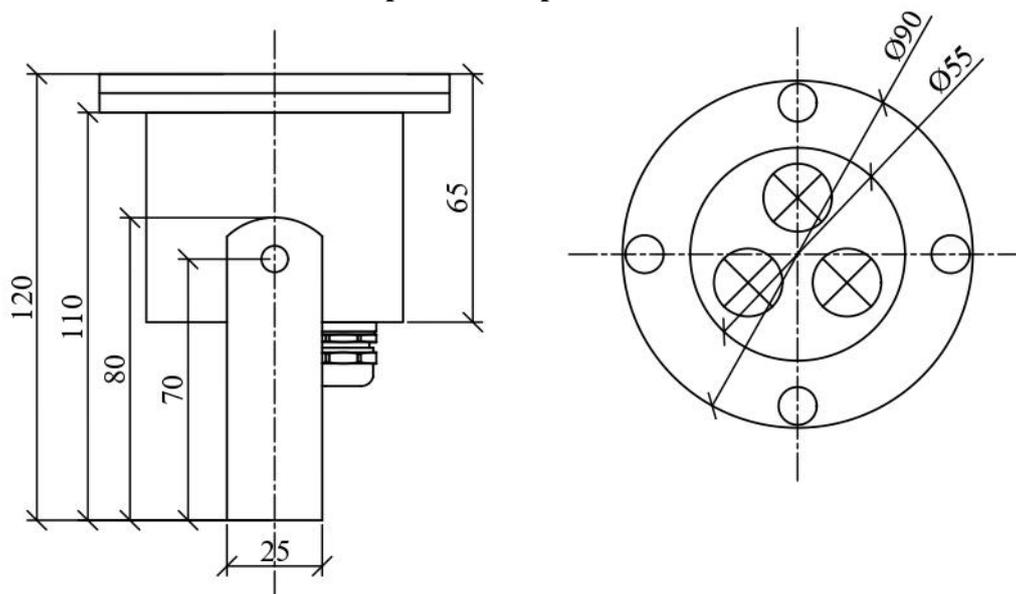
Конструкция прожектора не требует водяного теплоотвода и сохраняет работоспособность как при полном погружении, так и при надводном размещении.
